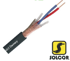
Cable STAGE Microfono Codigo: SC-200-0001 Calibre: 2X24 AWG Diam. Ext: 6.4 mm Color: Negro. Presentación: 100 mts.
